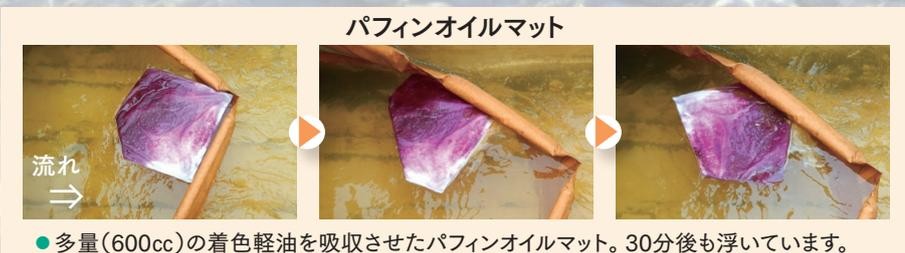
●多量(600cc)の着色軽油を吸収させたパフィンオイルマット。30分後も浮いています。
